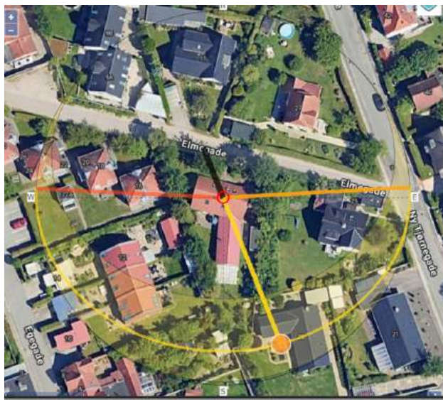
Figur 7 - Solens kurve ved Efterårsjævndøgn klokken 12.00 med skygge fra midten af huse
