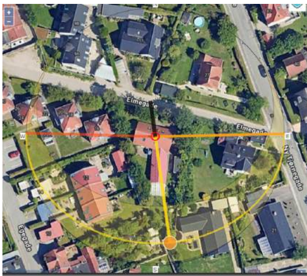
Figur 5 - Solens kurve ved Forårsjævndøgn klokken 12.00 med skygge fra midten af huset
